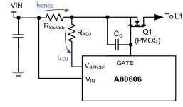
V<sub>IN</sub> – V<sub>SENSE</sub> = R<sub>SENSE</sub> × i<sub>SENSE</sub> + R<sub>ADJ</sub> × i<sub>ADJ</sub>
