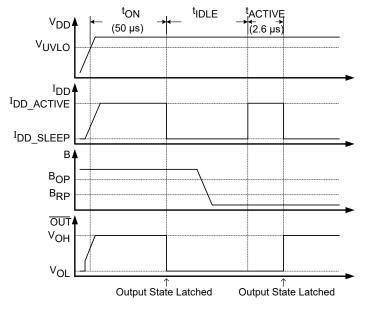
Figure 45: CT813x Power-On Timing Diagram
