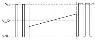
Figure 18e: Non-Synchronous Fast Decay
